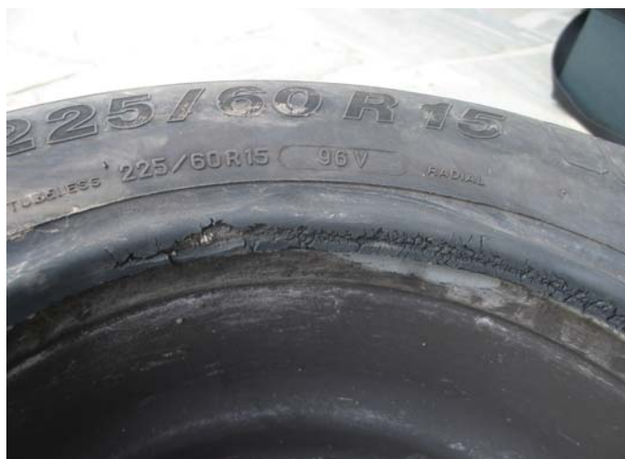
Bild 5: Überhitzungsspuren an der inneren Wulstsohle
