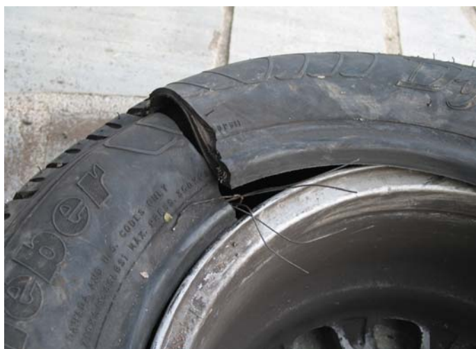
Bild 2: Reifenbeschädigung an der Innenflanke
